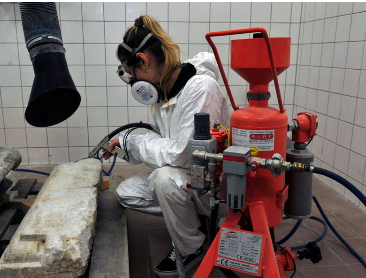
DAS NEUE STRAHLGERÄT DER STEINKLASSE IM EINSATZ
